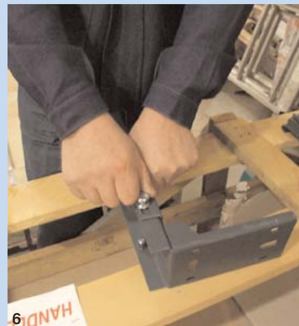
6. Фрагмент процесса сборки металлических кронштейнов для направляющих кабины лифта и противовеса
