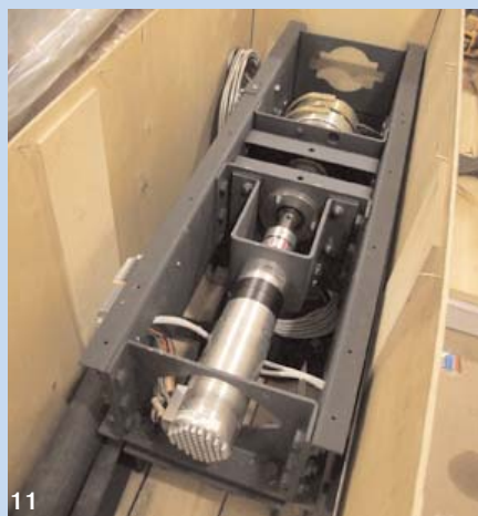
11. Рама лебёдки поставляется предварительно собранной с двигателем, комплектом КВШ и тормозом
